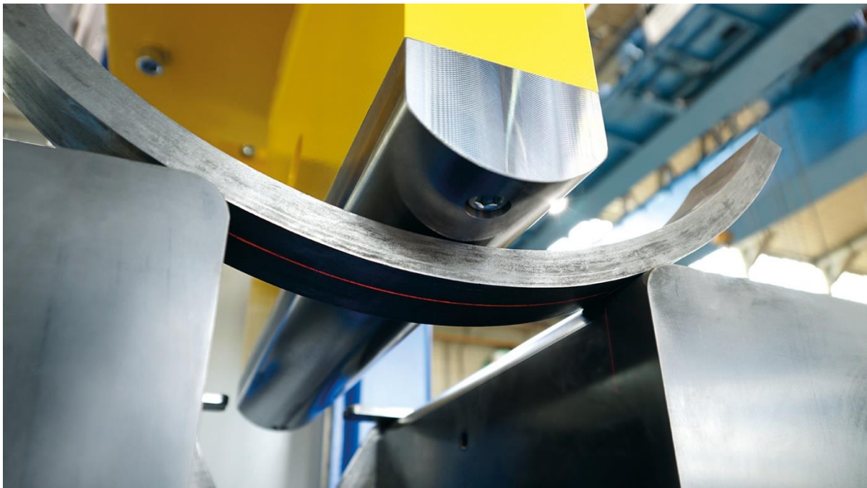
Elektronische Radienmessung mittels RadiiPro ®
