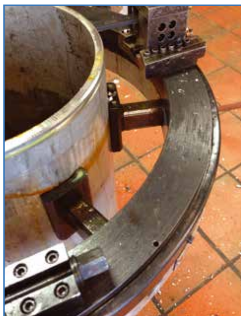
Spezialfüße als Option für dünnwandige Rohre
