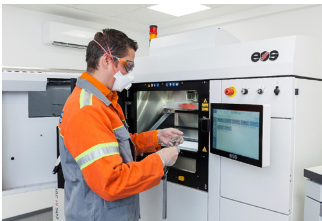
Bild 8: EOS M290, 3D-Drucker bei den Deutschen Edelstahlwerken (Quelle: DEW)
