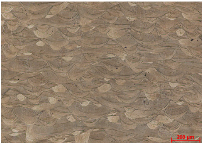
Bild 3: Lichtmikroskopische Gefügeaufnahme des Printdur HSA im gedruckten Ausgangszustand (Quelle: DEW)
