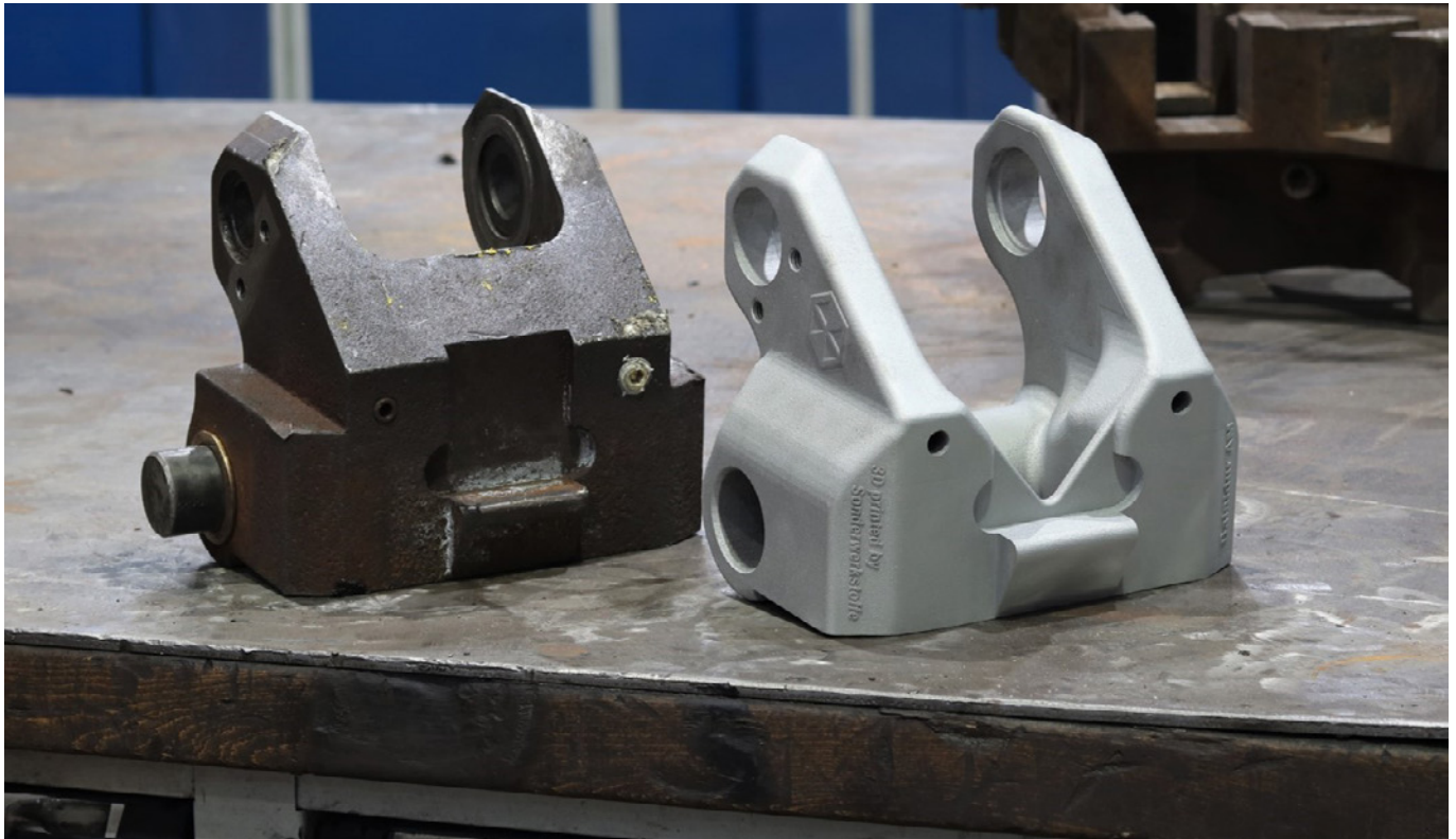
Bild 7: Führungsarm aus dem 420er Block Walzwerk Siegen (links: Original, rechts: Additiv gefertigt) (Quelle: DEW)
