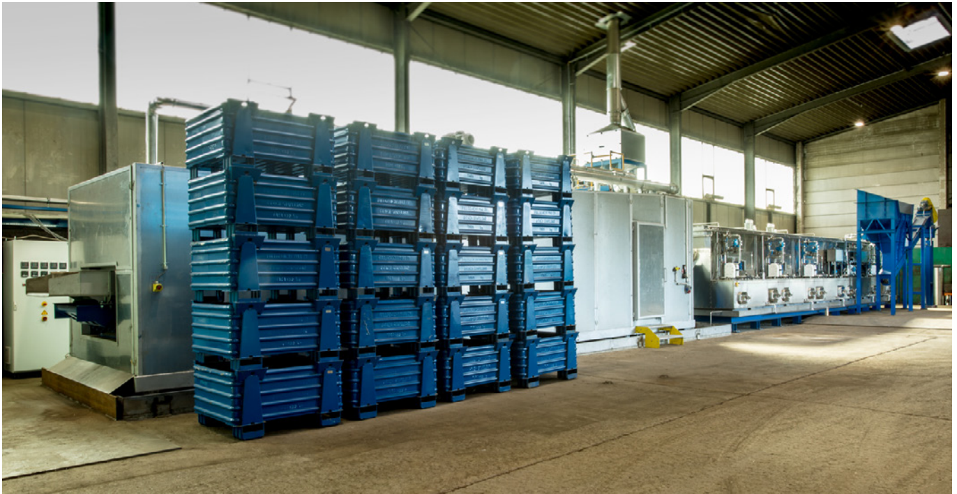
Bild 6: Anlage zur Entölung von Spänen der RHM Handelsgesellschaft mbH [20]
