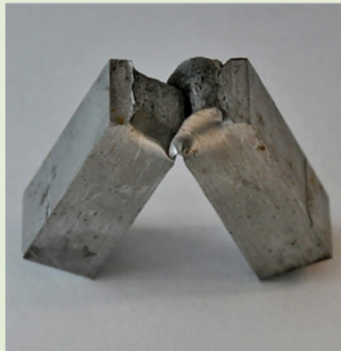
Bild 4: Unvollständig zerschlagene Probe nach dem Kerbschlagbiegeversuch
