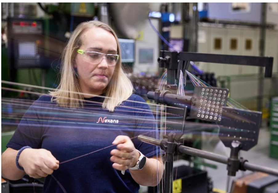
Nexans fertigt Glasfaserelemente für das Hochspannungs-Seekabel, das Malta über Sizilien mit dem europäischen Stromnetz verbinden wird. / Foto: Nexans
