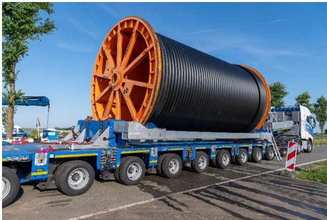
Das Erdkabel für die Trasse NordLink ist fertig für den Transport. ©TenneT
